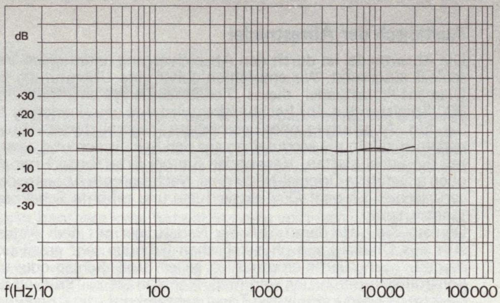
Ultraleichtes (ultra low mass) HiFi-Magnet-Tonabnehmersystem exclusiv nach Dual Spezifikationen gefertigt bei Ortofon. Durch die Masseverringerung auf ca. 1/3 der Masse üblicher HiFi-Magnet-Tonabnehmersysteme werden besonders günstige Abtasteigenschaften erreicht.
