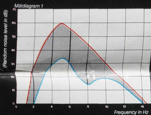
Mättdiagram 1 Statisk störningsnivå hos vanliga musikskivor, mätta med en tonarm med 18 g massa (röd linje) och med U.L.M.-tonarm med resonansdämpning med 8 g massa (blå linje).
