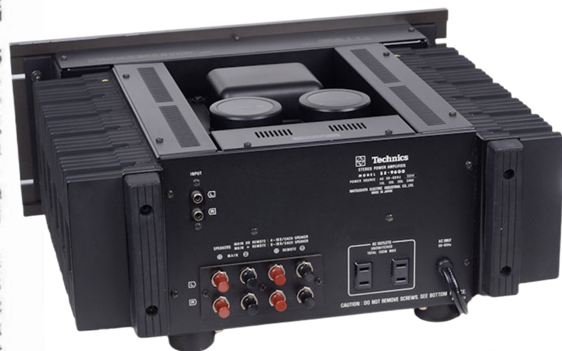
Fig 5. Slutstegets bakre panel. Att en polskruv kan ses avslagen hänför sig till ett transportmissöde under en demonstrationsturné. Hela kontaktplattan är utbytbar. Högtalaranslutningar med skruvad kabel. Märk de rejäla gummiklossarna och baksidans "balkar" av gummi, som förstärkaren kan vila på stående.
