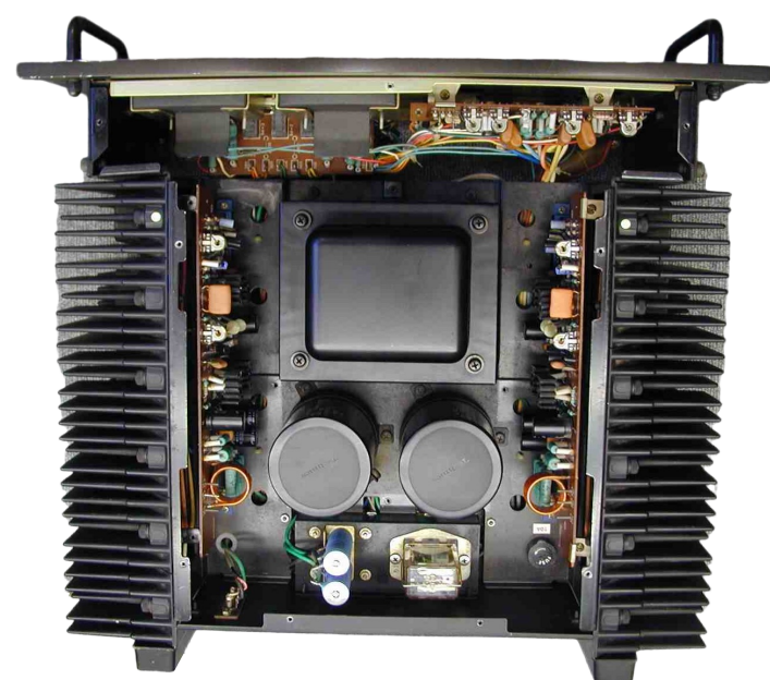
Fig 4. Så här ser slutsteget ut uppifrån. Trafo och jätte-ellytar ligger precis i mitten av det oerhört gedigna chassiet, där kylledningarna inte är skadligt vassa. Bra!
