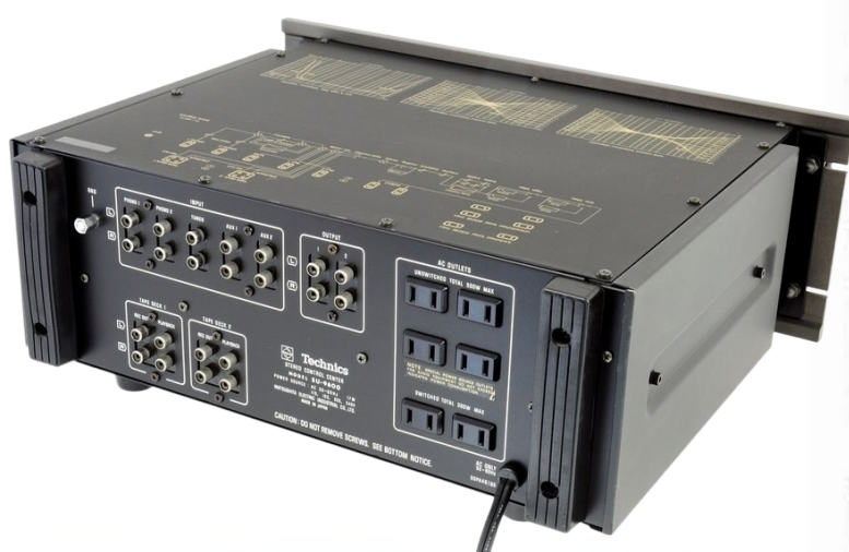
Fig 3. Den spaciösa ytan över förstärkarens bakre panel ger utmärkt plats för också stora kontakter till anslutningarna. Uttagen t h är förstas igenlagda i Sverige. Av fotot framgår inte hur dekorerat "topplocket" är med scheman och kopplingsexempel.
