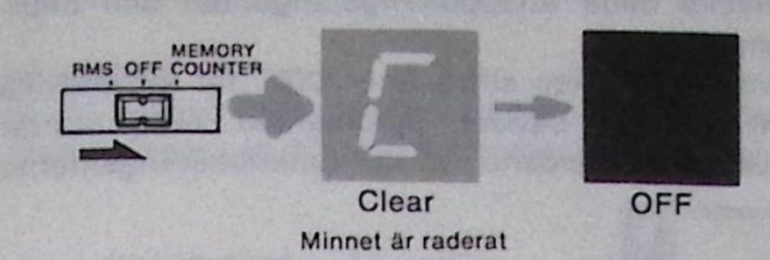
Under RMS-användning ställs RMS/MEMORY COUNTERomkopplaren i läge OFF. Tryck därefter ned stopptangenten för att stanna bandet.
