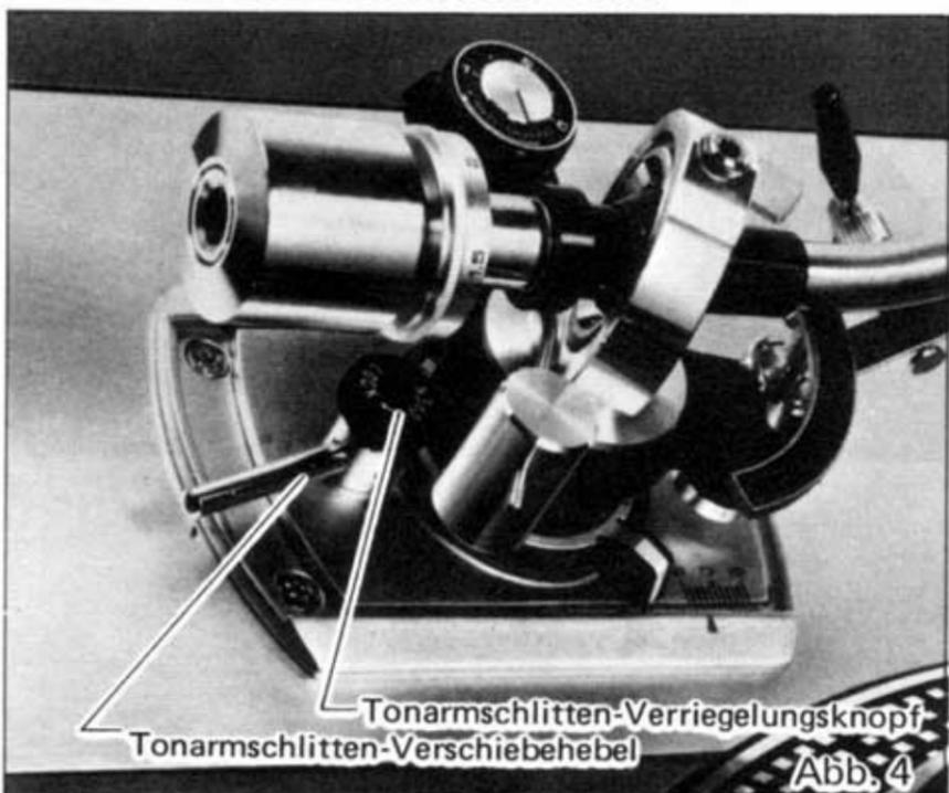
3. Die Tonarmbasis danach mittels Tonarmbasis-Verschiebehebel verschieben, bis die Abtastnadel 15mm entfernt von der Plattentellermittle angeordnet ist.
