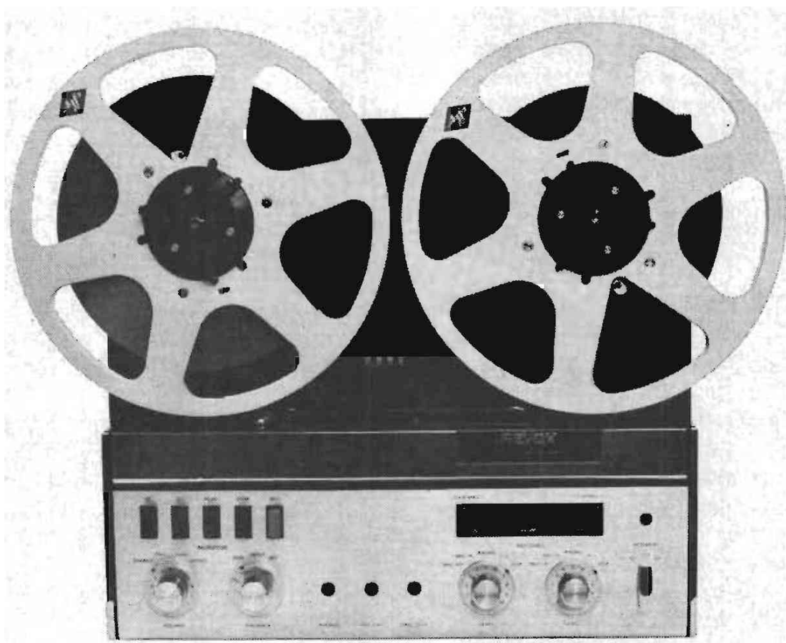
Fig 1. Fronten av Revox A 77. Maskinen kan som också tidigare modeller köras antingen liggande eller stående. Den är inkaplad i ett grått plastliölje och med en upphöjd panel nedtill som dock begränsar tillgängligheten till magnethuvudena under den nerfällbara luckan.
