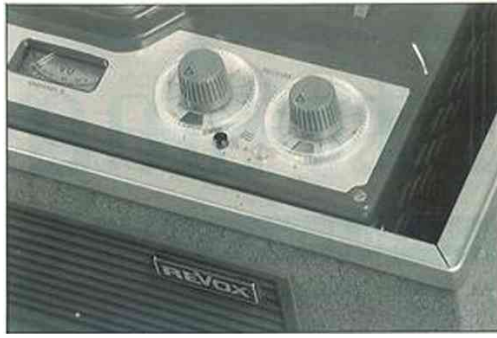
Den inbyggda kontrollförstärkaren hade blå egna tonkontroller på däckat till G-36 och bashöjning skedde genom vridning medsols av vredet. Med plexiglasskivan under slogs näströmmen på och av. Mellan bandspolarna fanns på G-36 en bandspänningsomkopplare man använde vid stora resp små bandspolar. Med en av de små knapparna mellan rattarna th kunde man välja inspelning på kanal 1 - vänster kanal, övre tonhuvudhalvan. Den andra knappen gav motsvarande höger kanal, nedre tonhuvudhalvan. Fines-seri.
