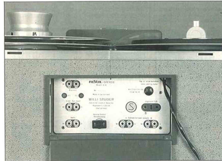
Alla Ingångarna baktill på ReVox var osymmetriska Katodföljargångarna var för resp anslutning till stereoförstärkare eller separata steg.
