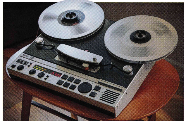
Danska Lyrec TRP 1 "Frida" är en professionell, portabel redigeringsbandspelare som endast, relativt för normalvikten för proffsbandare, väger 12 kg.
