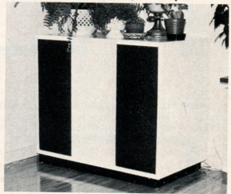
Fig 9. Lister, som sprutmålades samtidigt som högtalarlådan, täcker här skruvhålen för frontstycket. Listerna är något bredare än spånplattans tjocklek, 22 mm resp 16 mm, och ger därför en kant som håller skumplastbitarna på plats. Ett glest galler av tunna trälistor innanför skumplastbitarna hjälper till att hålla dessa plana. Skumplast kan anskaffas från LW Ljudteknik, tel 08-29 07 76. (Skumplasten har givetvis bara en estetisk funktion att fylla.)
