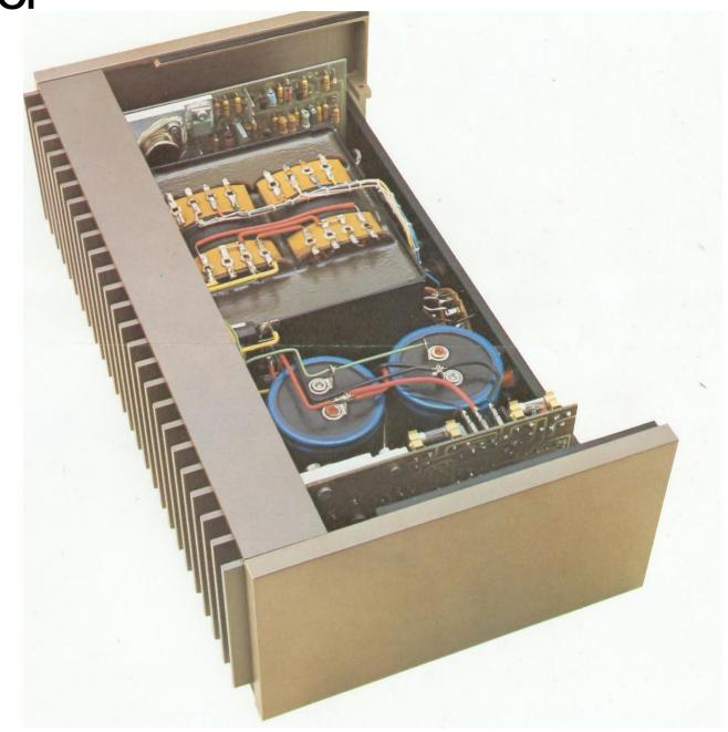
Stromablader (Current dumping) ist die Bezeichnung für eine völlig neuartige, bei Quad entwickelte NF-Verstarker-Endstufe, bei der die Linearität der Endtransistoren, die den Hauptstrom liefern, keinen Einfluß auf die Gesamteigenschaften des Verstärkers hat, so daß die Notwendigkeit der Vorspannungs-Einstellung sowie alle Probleme, die mit den Ubernahmeverzerrungen Zusammenhängen, beseitigt sind.
