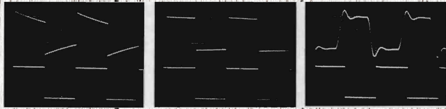
Fig 16. Kantvågssvaret för effektförstärkaren vid samma frekvenser som i fig 15. Här är dock belastningen 8 ohm parallellt med en kondensator om 1 µF.
