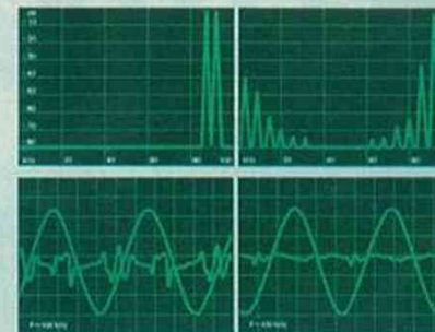
Uppre: Övertoner ovanför den övre hörselgränsen får inte orsaka distorsionsprodukter som återverkar ned i det hörbara området. Nere: En förstärkare får inte ha övergångs-distorsion som t.v.I Pioneers nya nonswitching-förstärkare finns ingen distorsion t.h.
