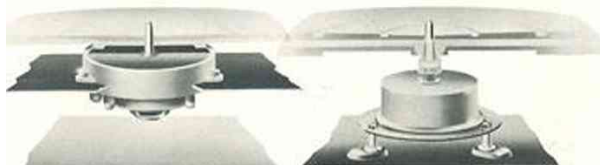
I STÄLLET FÖR ATT MOTORN HÄNGER I FJÄDRAR, SITTER PIONEERS FÖRANKRAD SÅ VIBRATION INTE KAN PÅVERKA MUSIKEN.
