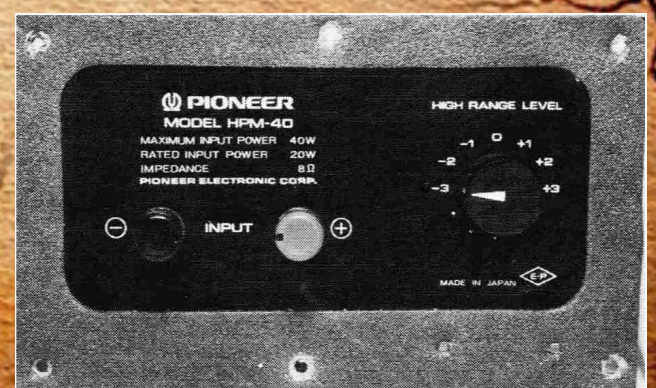
Filtret från baksidan av högtalaren. Observera snabbanslutningskontakterna.
