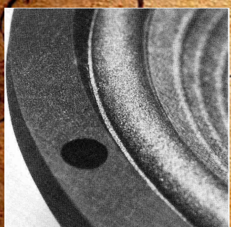
Här visas den viktiga kanten på membranet. Kanten som skall stoppa alla kantreflexer.
