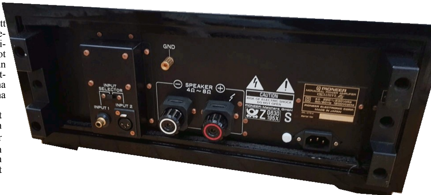
Monoblockens baksida med de rejält tilltagna polskruvarna. Ingångens balanseringstransformator (1:1) sitter i en skärmd låda utanför själva chassiet, för maximal störningsfrihet från nätdelen. Jordskruven kan användas för att kunna stjärnjorda varje enhet.
