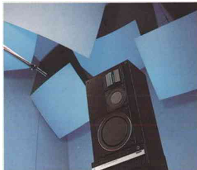
In de Philips laboratoria worden fundamenteel nieuwe technieken ontwikkeld voor geluidswaergave. Hiernaast een proefopstelling voor het testen van vlakmembraan luidsprekers.
