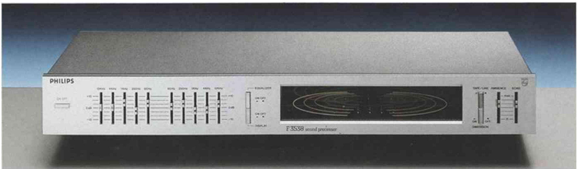
Philips soundprocessor F 3538 met 2x5-bands equalizer, regelbare stereodiepte en stereobreedte-instelling (ambiance), regelbare nagalm en uniek driedimensionaal geluidsveld display.
