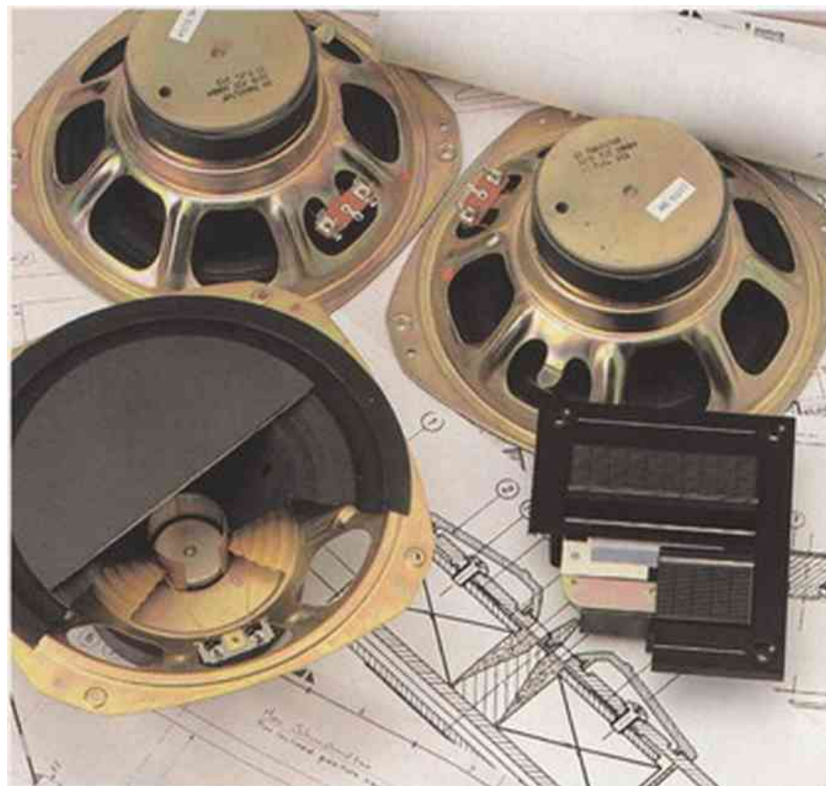
Actieve woofer met vlak, stijf en uiterst licht membraan. Geen inkapseling van hoog door laag, geen tunneleffecten en uiterst lage vervorming.
