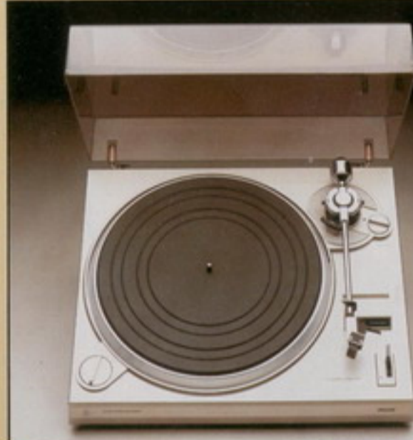
F 7112 Semi-automatische HiFi platenspeler. Snaaraandrijving. Jengel 0,05% WRMS, rumble -60 dB DIN-B. Instelbare dwarskrachtcompensatie en naaldkrachtmeter. Super-M HiFi element GP 500.
