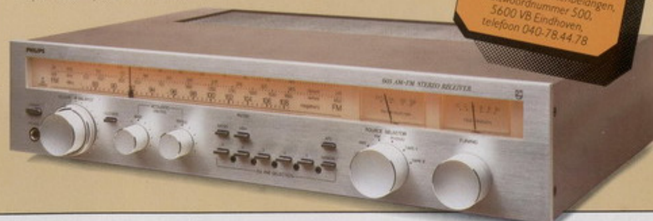
AH 603/60 HiFi receiver. Uitgangsvermogen 2 x 30 W FTC. FET tuner met FM (stereo/mono), MG, LG, 5 FM-voorkeuzers, kanaalmidden-afstemming. Geïntegreerde stereooversterker met loudness-en ruisfilter, stereo/mono schakelaar, 4 luidspreker- en 2 recorder-aansluitingen. Geslepen metalen front, breedte 450 mm.
