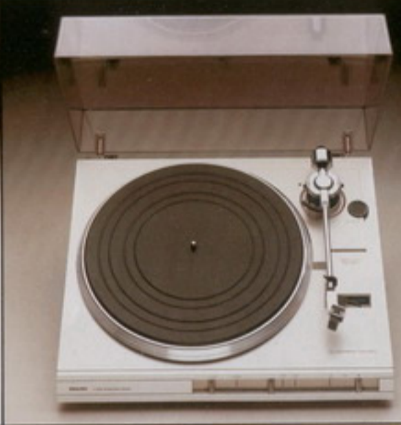
F 7211 Automatische HiFi platenspeler. Frontbediening. Snaaraandrijving. Jengel 0,05% WRMS, rumble -60 dB DIN-B. Instelbare dwarskrachtcompensatie en naaldkrachtmeter. Antimagnetische draaitafel. Super-M HiFi element GP 500.
