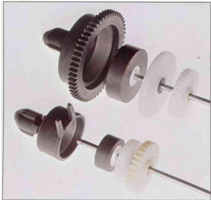
Hysteresisfrictie. Een unieke magnetische koppeling op de opwikkel- en de afwikkelas, door Philips geconstrueerd, waardoor elk rechtstreeks contact tussen aandrijving en spoelstel overbodig is geworden. De aangewezen techniek ter voorkoming van rumble en slijtage, waardoor bovendien • samen met de tachogeregelde motor • een constante bandspanning en soepel bandtransport worden gewaarborgd.
