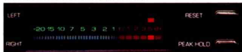
Na afloop van de opname wordt het maximaal bereikte oversturingniveau via 'peak-hold' aangewezen.
