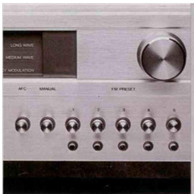
Elektronische afstemming op vijf FM voorkeuzers, gekoppeld aan verlichte naaldindicator voor FM voorkeuringstelling en inschakeibare automatische FM lijnafstemming (AFC).
