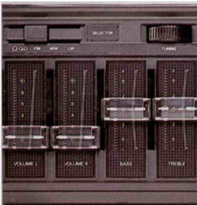
Gemakkeh/ke schuifregelaars. Voor tiet haarfijn regelen van de geluidsterkte links en rechts (stcreobatan). lage en hoge tonen
