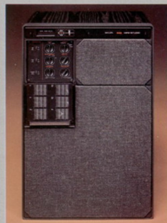
RH 545/00R – Motional Feedback HiFi luidsprekerbox met drie ingebouwde eindversterkers, drie luidsprekers, twee elektronische scheidingfilters, lage- en hogetonenfilters en 100 watt continu vermogen.
