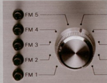
Centrale programma-selector. Voor keuze van vijf FM voorkeuzerstations FM manuaal, middengolf, platenspeler, tape A en tape B.
