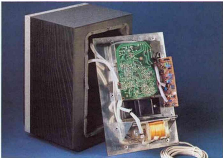
Eingebaute Leistungs-Elektronik einer MFB-Box
