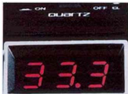
Die geringste Abweichung, die der Tacho-Generator registriert, bedeutet gleichzeitig ein elektronisches Regel-Signal für den Antriebsmotor. Durch diesen elektronischen Regelkreis wird die Soll-Drehzahl äußerst konstant eingehalten. Das Ergebnis ist optimaler Gleichlauf. Eine Voraussetzung für die aufnahmegetreue Schallplatten-Wiedergabe.
