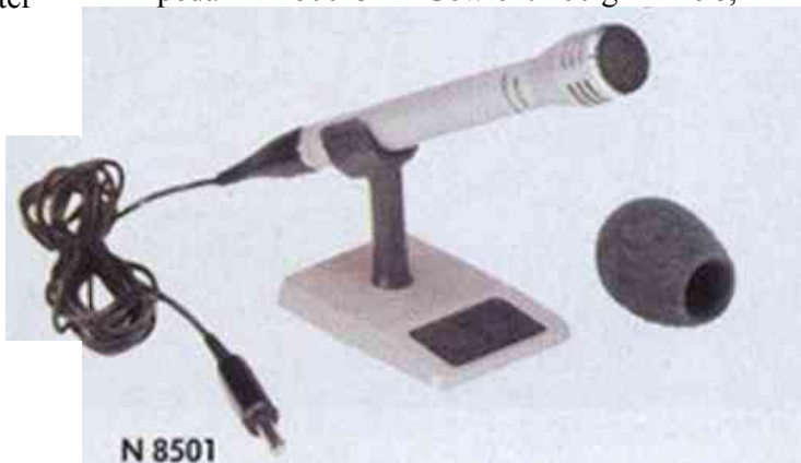
N 8501 HiFi Electret-Mikrofon Super-Nierencharakteristik. Empfindlichkeit 0,35 mV/pbar. Frequenzbereich 50 18 000 Hz (DIN 45 500) Ausführung Klinkenstecker 6,3 mm. Mit Tischstativ und Windschutz für Nahbesprechung. Stativgewinde V» DM 125, *
