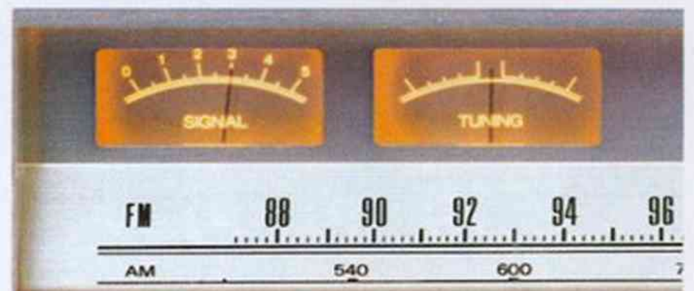
Feldstärke-Instrument (Signal) und Anzeige der Sender-Abstimmmitte (Tuning).
