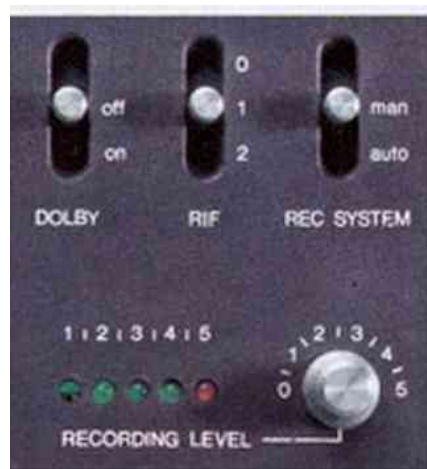
Übersichtliches Bedienungsfeld mit Funktionsschloß für das rauschunterdrückende DOLBY-System, für RIF und wahlweise Automatik- oder Hondaussteuerung durch Emjieller und Leuchtdiodenkette
