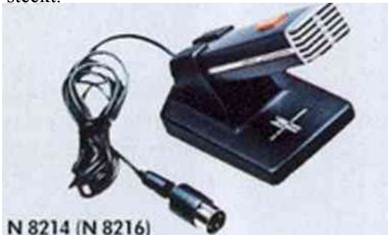
N 8214 (N 8216) HiFi-Electret-Mikrofon mit Schalter Kugelcharakteristik. Empfindlichkeit 0,25 mV/pbar Frequenzbereich 50 15 000 Hz (DIN 45 500) Impedanz 800 Ohm Ausführung: N 8214/00 mit 3pol. 180 -DIN-Stecker mit Ein/Aus-Schalter für das Mikrofonsignal N 8216 (o Abb.) mit 2 Klinkensteckern, 3,5 mm für die NF, 2,5 mm für Start/Stop DM32. *
