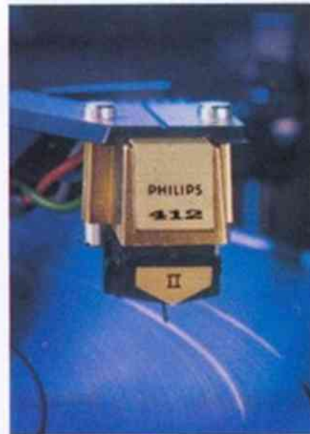
SUPER M 412 II – das seit Jahren bewährte System der Spitzenklasse. Elliptischer Diamant, empfohlene Auflagekraft 0,75–1,5 p.
