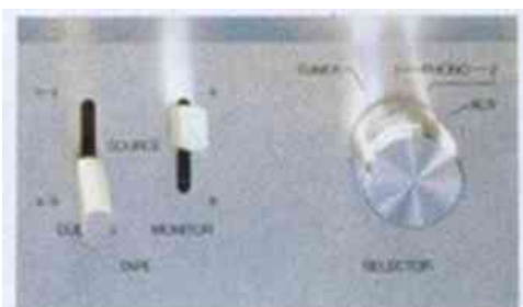
Der Dubbing-Schalter für separates Überspielen von Band a zu Band b oder umgekehrt. Daneben der Monitor-Schalter zum Abhören der beiden Tonbänder und rechts der Eingangsschalter für den Tuner, für zwei Plattenspieler und den Reserve-Eingang.
