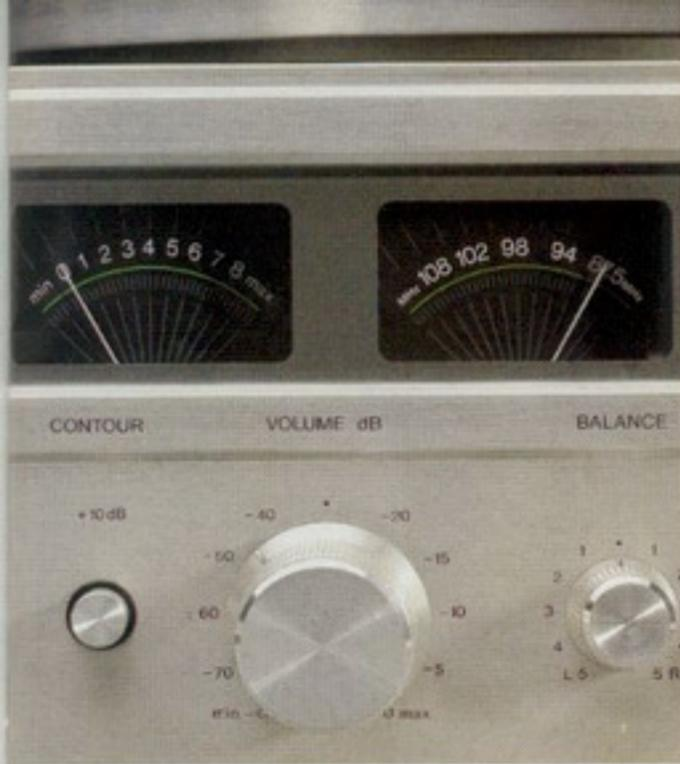
**Übersichtlich beleuchtete Anzeigen-Instrumente**, links zur Abstimmhilfe für punktgenaue Senderabstimmung, während das rechte Anzeigenfeld die Frequenzanzeige der Stationsspeicher visualisiert.
