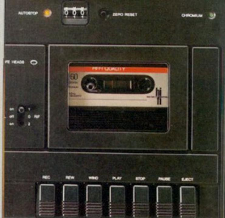
**Cassetten-Tonbandgerät** mit elektronischer Gleichlaufregelung des Antriebsmotors, automatischer Bandsortenumschaltung, automatischer Bandaussteuerung, automatischer Bandendabschaltung und anderem Bedienungskomfort.
