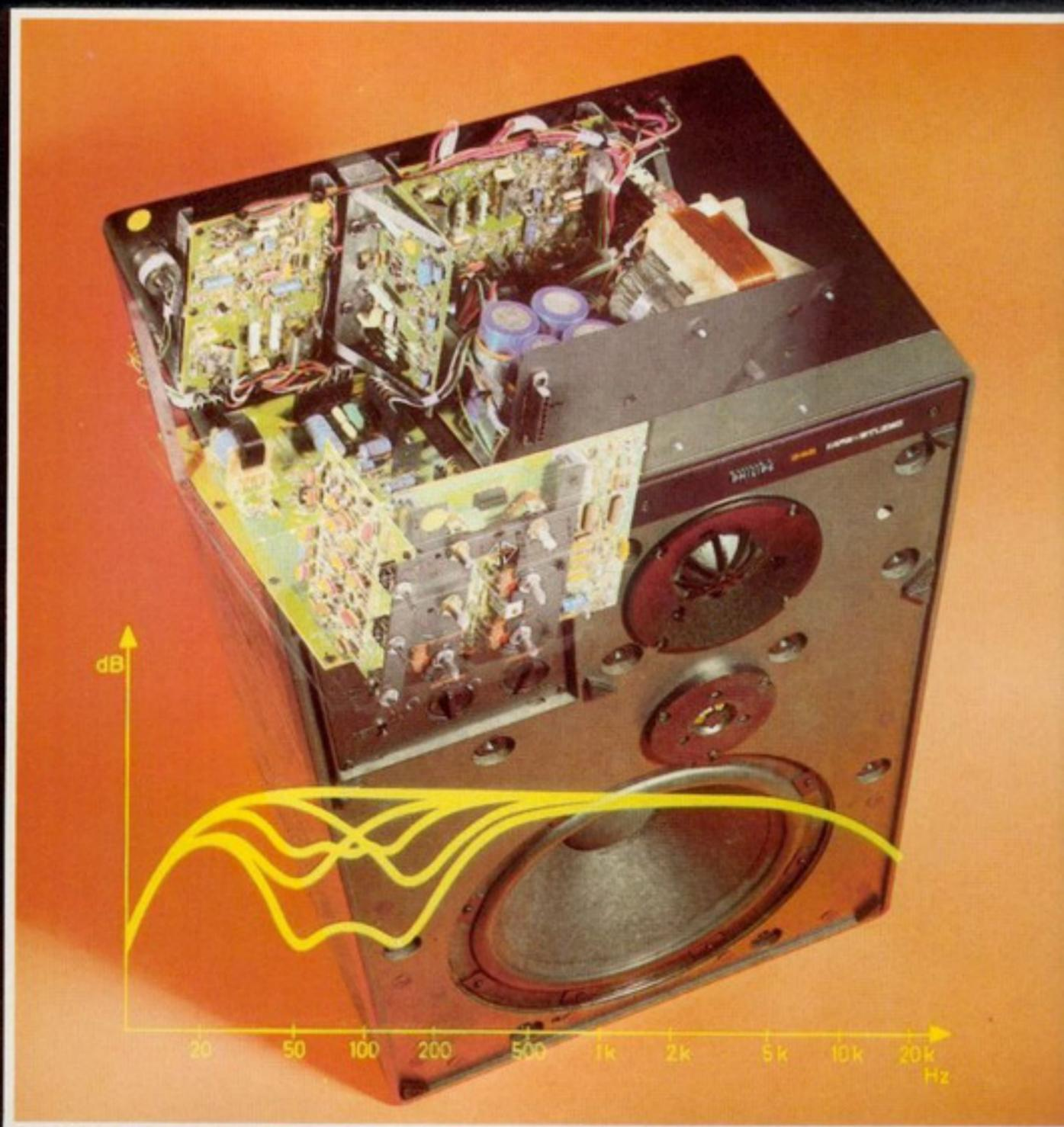
erkennt. Die vom Komparator erkannten Abweichungen werden dann als Korrektursignal zum Verstärker zurückgeführt und dort dem Steuer-Tonsignal gegengekoppelt (Abb. 1). So werden die ohne MFB unvermeidbaren Bewegungsfehler der Tieftonmembrane blitzschnell ausgeregelt. Das abgestrahlte akustische Signal entspricht dem elektrischen, originalen Steuer-Tonsignal; Bässe kommen unverzerrt und klargrein aus dem Lautsprecher.
