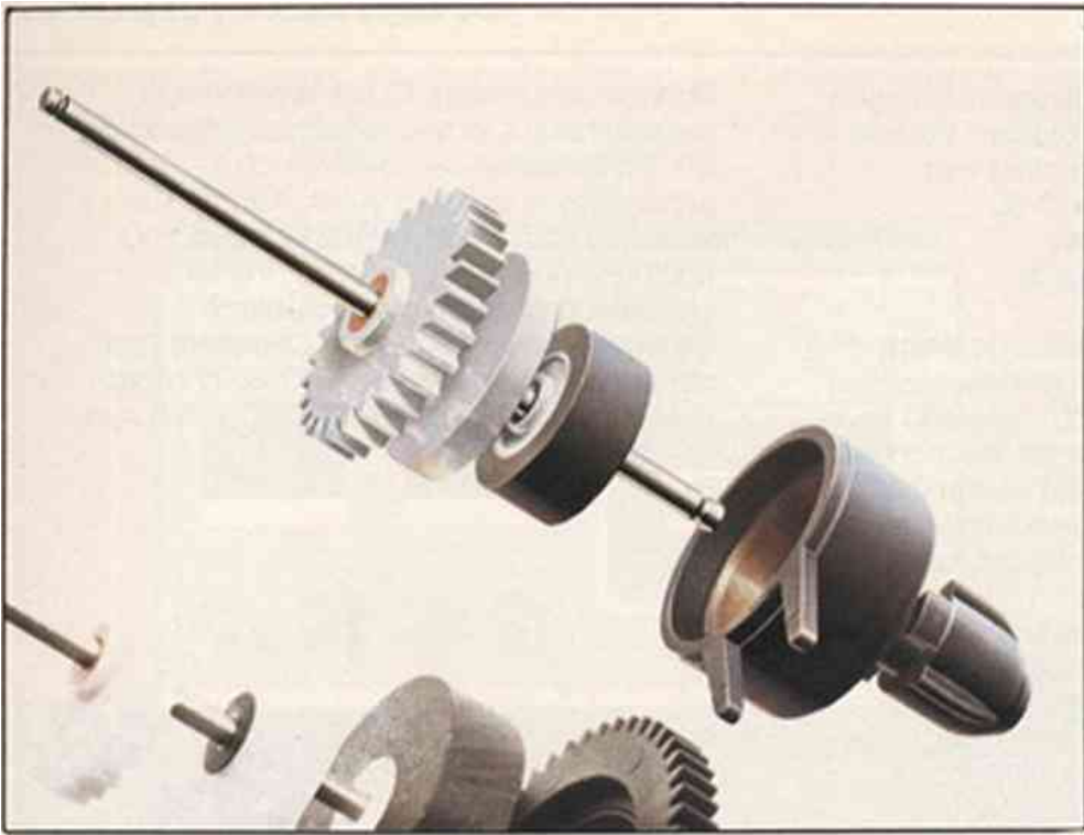
Hysteresisfunctie op de alu- en opwikkelas. Wrijvingsloze magnetische overbrenging. Kan niet schieten en zorgt ervoor dat de band altijd strak tussende koppen loopt.
