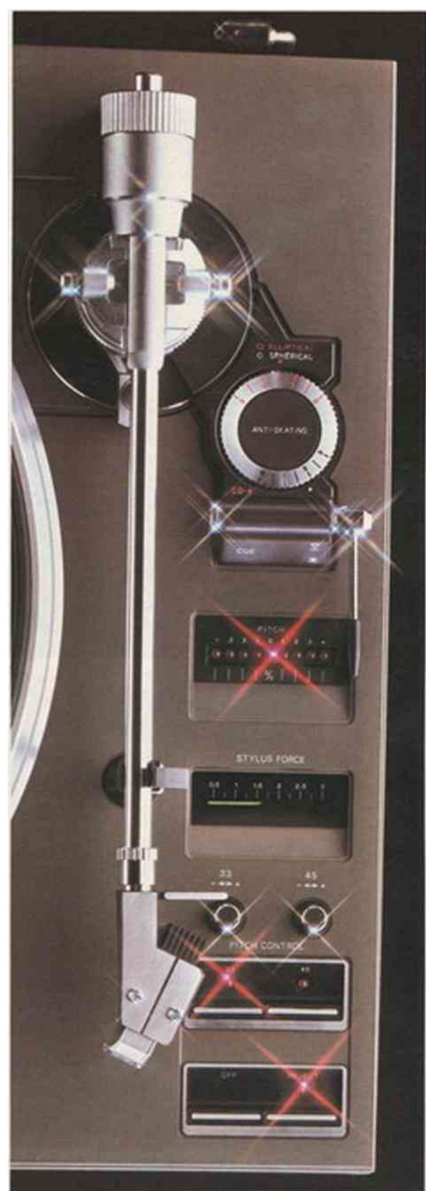
Overzichtelijk bedieningspaneel met precisie-instelling voor dwarskrachtcompensatie, handle voor armlift, LED-schaal voor aflezing snelheid, naaldkrachtmeter, draairegelaars voor snelheidsbijregeling, LED-tiptoetsen voor snelheidskeuze (33 of 45 t.p.m.), uitschakelen en reject.
