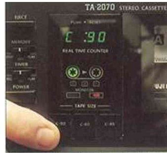
Vill man under inspelningen ha reda på hur lång speltid man har kvar på kassetten så trycker man in knappen för kassetts längd. I detta fall C90. Då räknar apparaten ut kvarvarande spel tid.
