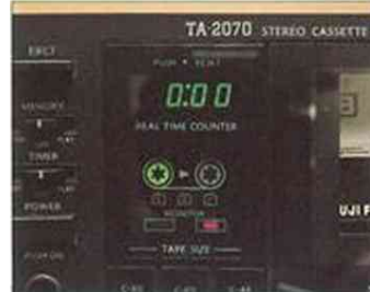
På frontens vänstra sida finns näldrömbrytare, knappar för timer och bandtinte (Autostopp och autoreplay), uttag för hörlurar och sist men inte minst det avancerade räkneverket. Räkneverket är här nollställt och när den högra bandrullen i kassettsymbolen lyser så innebär det att man räknar tiden när bandet löper från denna rulle.
