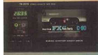
Den resterande speltiden visas på displayen och anges i minuter och sekunder. Dessutom visas med röd text om man lyssnar före eller efter inspelningen.
