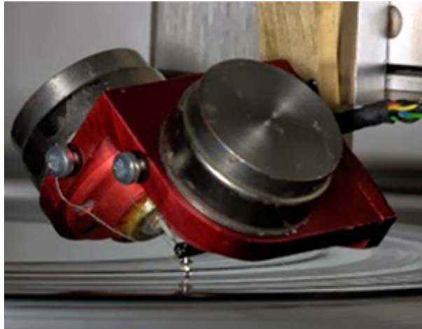
Vinylum SC-99 skärhuvud som graverar moduleringen lateralt och vertikalt tvärs rotationsriktningen. [källa: illusionofsound]
