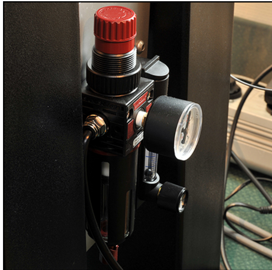
Regulatorn till SYD Aeroarm som ger 1.5 bars arbetstryck och ett flöde av ca 0.5 l/min.
