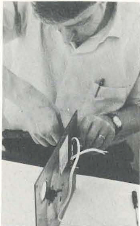
Det var lite knepigt att få fast låsringen på manöverarmen för strömbrytaren.
