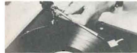
Tonarmens höjd i förhållande till skivtallriken justeras in med pickupen liggande på en skiva.
