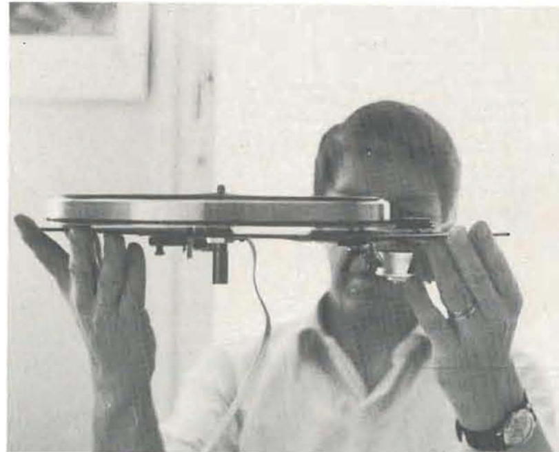
Så här ser den färdigkopplade skivspelaren ut underifrån. Observera jordningsförbindningen mellan motor och tonarmen.
