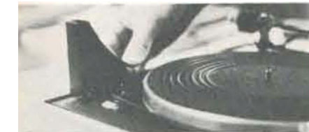
Vid byte av hastighet från 33 varvs-hastighet till 45 låter man drivremmen löpa över drivhjulet med den största diametern.
