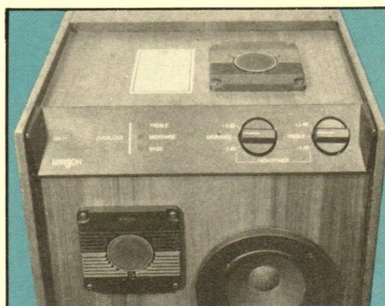
OM 71 har både överstyrningsindikatorer och nivåkontroller.
