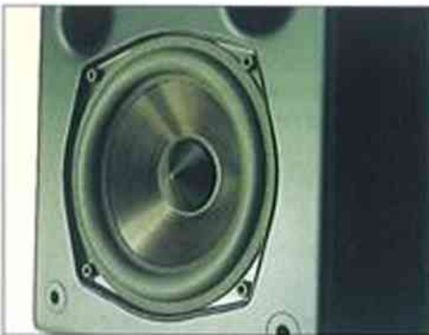
En fördel med metall-membran är att de har svårt att bryta upp. Men när det sker, så sker det dess mer. Därför används branta filter.
