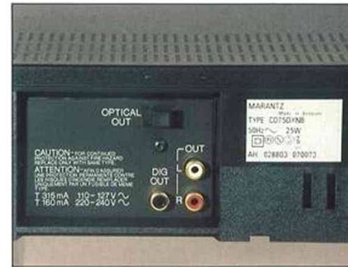
På baksidan finns förutom de vanliga analogutgångarna även en digital koaxial utgång och en optisk utgång för fiberoptik.
