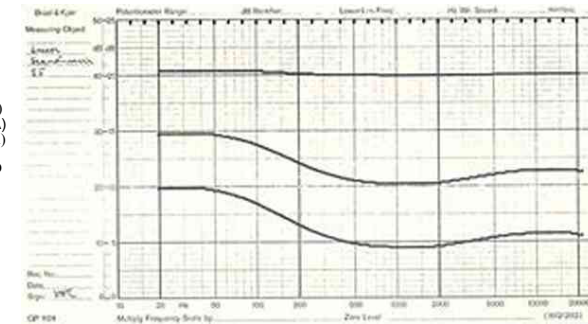
Frekvensgång med loudness inkopplad och volymkontrollen i läge kl 9, kl 12 och kl 3
