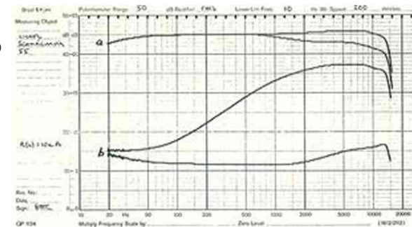
Frekvensgång, stereo a. och Stereoseparation b. ("hi blend" inkopplad)
