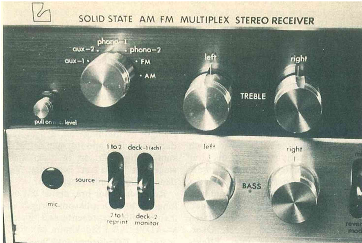
Fig 4. Här ser vi den vänstra delen av fronten. Ingångsväljaren uppe till vänster, snett därunder mikrofonratten och de kanal-delade tonkontrollrattarna. Spakarna nedtill bestämmer bandspelarfunktionerna.
