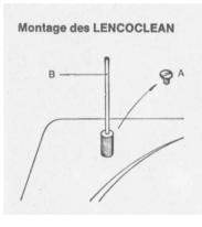
Oie Plattenreinigungsvorrichtung LENCOCLEAN, welche die Platten während des Abspielens reinigt und befeuchtet und hierdurch sowohl die Abspielgeräusche auf ein Minimum herabsetzt als auch die Lebensdauer der Platten um ein Vielfaches verlängert, kann in einfachster Weise auf den B 52/B 55 montiert werden.
