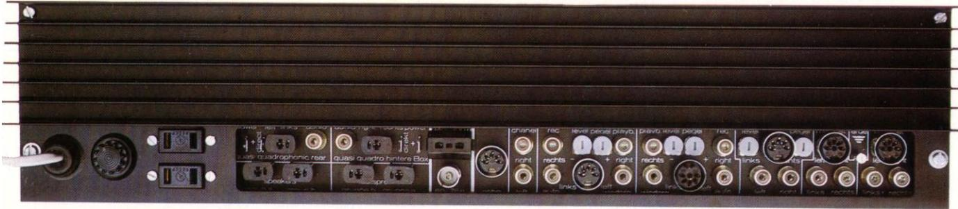
Stecker-Anschlußplatte mit parallelen Anschlüssen deutscher und ausländischer Normen, sogar mit Pegelsteller und coaxialem UKW-Anschluß.
