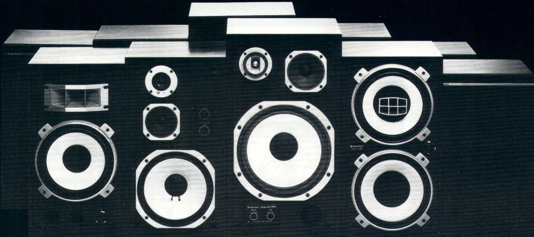
**LS-660 - 70 Watt-Lautsprechersystem.** Ein außergewöhnliches Zweiweg-Doppellautsprechersystem, das zur Verbesserung der Richtwirkung mit einem senkrecht unterteilten bogenförmigen Hochtöner ausgerüstet ist.
