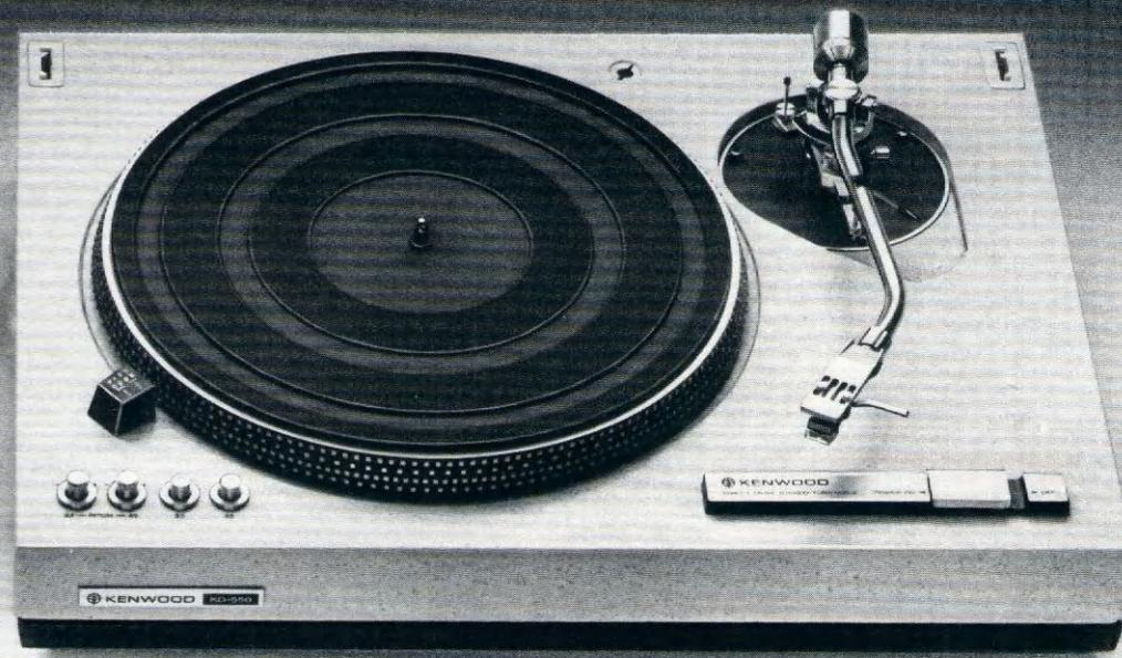
Plattenspieler mit Direktantrieb KD-550. Ein Plattenspieler in Studioqualität mit Direktantrieb durch einen kollektorlosen Spaltpolmotor mit Servosteuerung. Die Drehzahlregelung erfolgt durch einen besonderen, von der Netzfrequenz unabhängigen NF-Generator. Der neu entwickelte massearme Rohrtonarm garantiert eine äußerst exakte Rillenführung des Abtastsystems.
