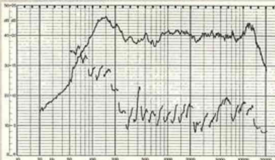
Verkningsgrad: 0.20 % Frekvenskurva. 0-nivån = 50 dB rel. 1 pW. övertonskurva. 0-nivån=30 dB rel. 1 pW. Skala: avståndet mellan varje skalstreck = -1 dB. Tonkontr. i max-läge. Högtalaren mätt 1.15 m över golv mot vägg. Verkningsgraden baserad på uppmätt nominell impedans
