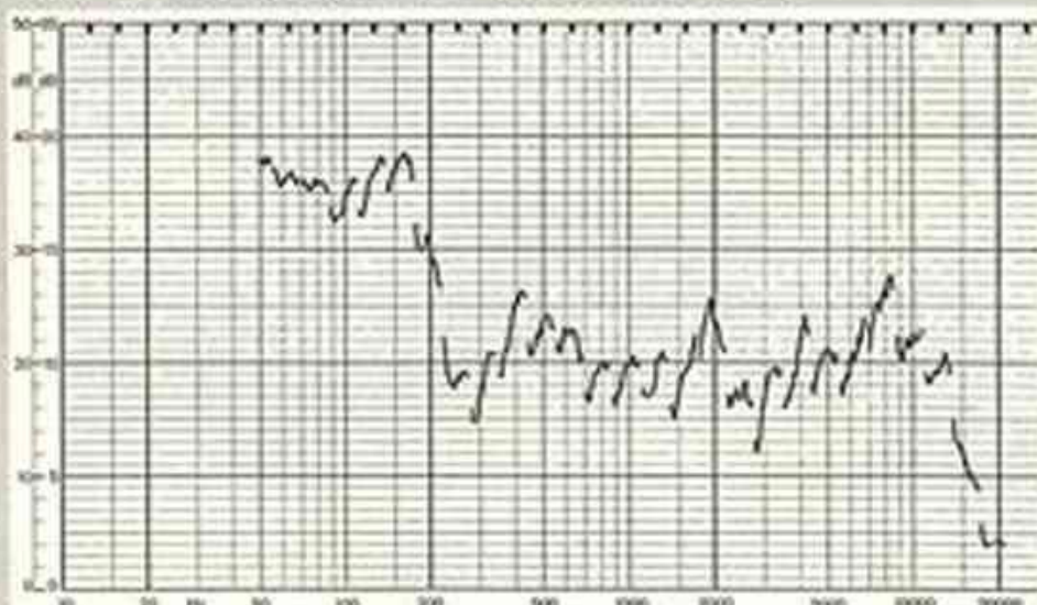
Övertonskurva. 0 nivån = 40 dB rel 1 pW Mätt med 10 dB högre tillförd effekt än tonkurran
