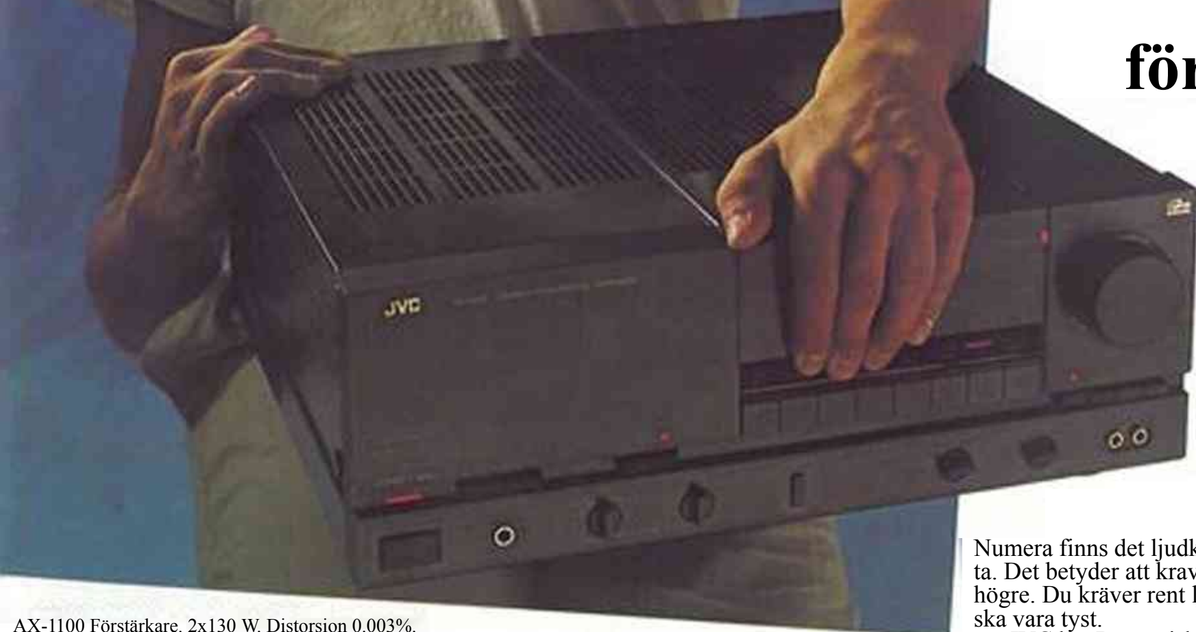
AX-1100 Förstärkare. 2x130 W. Distorsion 0.003%. S/N 103 dB (MM) Ingångar för MM och MC pick-up samt 3 digitalkällor.
