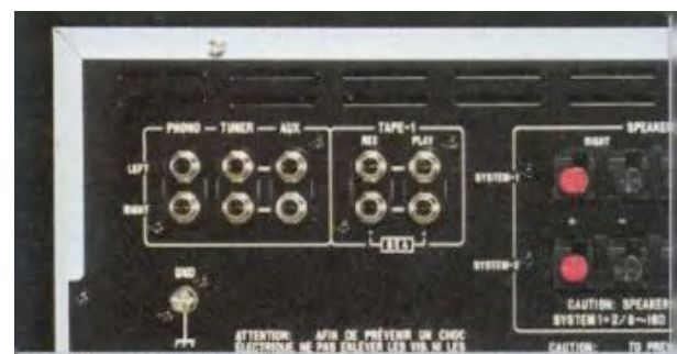
Ein-/Ausgangsanschlüsse an der Geräterückseite (JA-S44)
