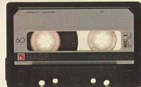
8. Kassetter med stort rullmotstånd ger svajig ljudåtergivning.
