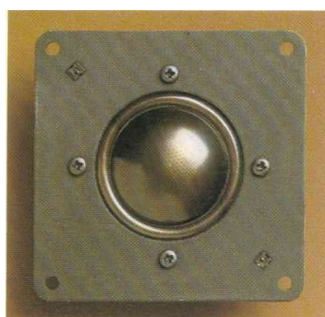
Heute: Anschlußleitungen innen verlegt, keine Berührungsgefahr, definierte Lage auch nach Jahren.
