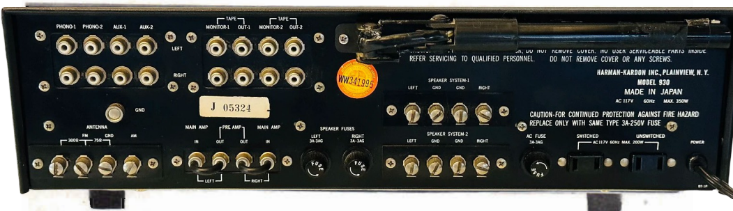
Fig 2. Bakre panelen till H/K 930. Märk de metalliserade byglarna för de båda förstärkarstegen separering. Konventionella skruvlistor och kontakter. Påfallande är att konstruktören inte ansett sig behöva disponera bakstycket för sluttransistorernas kylning — här finns inga "heat sinks" om leder ut värme direkt mot omgivningsluften. Jämför t ex den i novembernumret provade Sony-förstärkaren.
