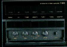
Regler/Schalter unter Alu-Klappe (Taste Tuner gedrückt).
