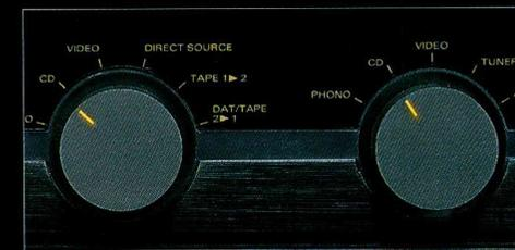
Cross-Mode: Beim Hören einer Signalquelle ist die Aufnahme einer anderen möglich.
