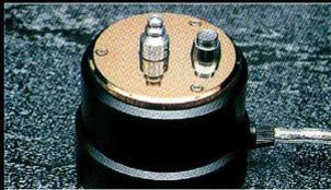
*Außenläufermotor mit hoher Schwungmasse, System Papst.*
