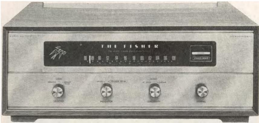
UKW-Multiplex-Tuner. Empfangsbereich: 88 . . . 108 MHz — Empfindlichkeit je nach Antenne 0,7 (µV - 2,2 µV — Selektivität: 55 dB — Störabstand (bei 100% Modulation) 70 dB — NF-Frequenzgang: 20 ... 20 000 Hz ± 0,5 dB - UKW-Stereo-Kanaltrennung: 35 dB bei 1 kHz — NF-Ausgang: 2 Volt — Verzerrung: < 0,2% bei voller Aussteuerung — 10 Röhren mit 15 Funktionen — Stromverbrauch 42 Watt — Abmessungen: Breite 384 mm, Höhe 122 mm, Tiefe 300 mm — Gewicht: 6,3 kg. Ohne Gehäuse.
