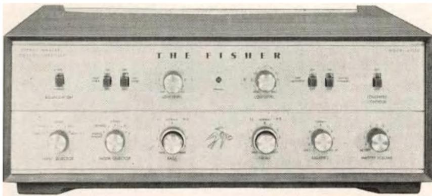
Hi-Fi-Stereo-Verstärker mit 2 x 20 Watt Ausgangsleistung (Musicpower). Nichtlineare Verzerrung < 0,5% — Frequenzgang 20 . . . 20 000 Hz  $\pm$  1 dB - Störabstand 90 dB - Übersprechdämpfung > 50 dB — 6 Eingänge — Einzelregelung von Höhen und Bässen für jeden Kanal — Rumpelfilter — Höhenfilter — 10 Röhren mit 14 Funktionen — Ausgänge: 4, 8 und 16 Ohm + Phantom-Kanal — Stromverbrauch 160 Watt — Abmessungen: Breite 384 mm, Höhe 122 mm, Tiefe 318 mm - Gewicht: 10 kg. Ohne Gehäuse,
