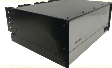
Bild 7. (ovan) Den senaste modellen av Dynacos högeffektförstärkare heter Stereo 410. Förstärkardelen är identisk med modell 400 men höljiet är annorlunda utformat och effektbegränsningen "Dynaguard" har slopats
