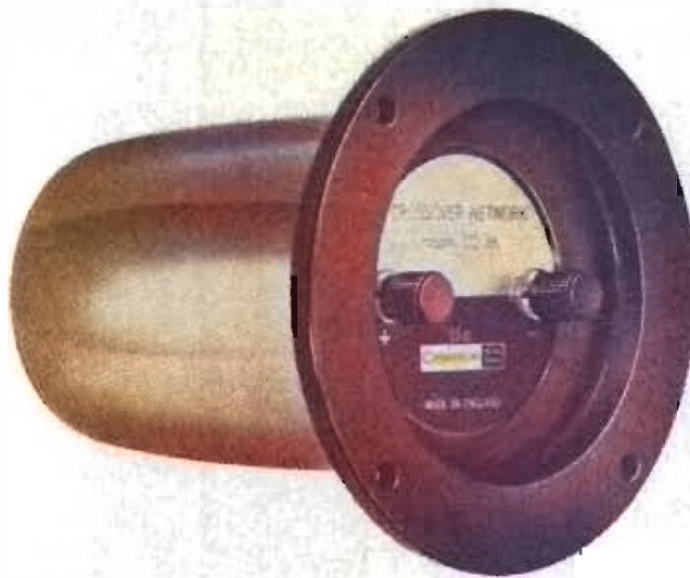
Fig 4. Delningsfiltret CO3K. Märk högtalaranslutningarna (röd och svart märkning).
