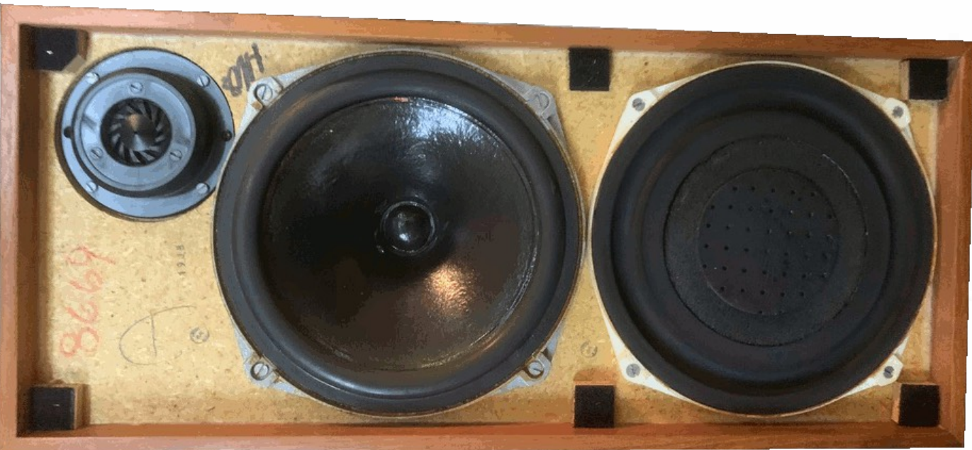
Fig 2. Ditton-högtalaren med fronten avtagen. T v diskantelementet HF1300 MK2. HF1300 MK2 är tidigare provat i RT ( klicka här för att läsa ), och bredvid — i mitten — bashögtalaren samt slavenheten som drivs av den förra.
