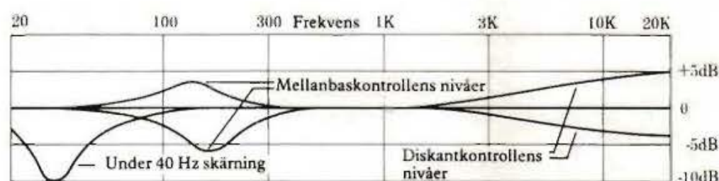
Fig. 5. Med ekvalisatorn kan bl a mellanbas- och diskantåtergivningen förändras inom ett par dB. De olika tonkurvor som man kan få fram går av figuren. ▶
