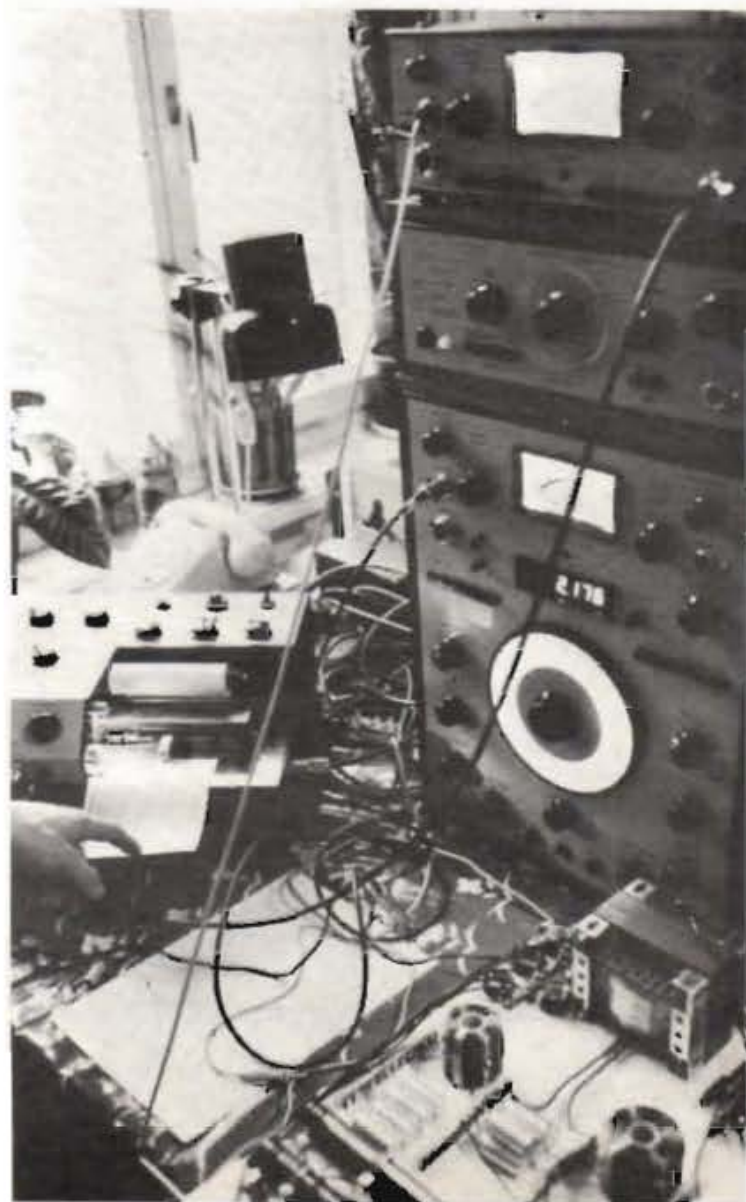
Fig. c. Högtalarna mättes in med svepförfarande och synkrona skrivarupptagningar av utsignalstyrningen över matmikrofonen.
