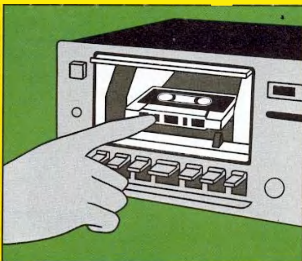
Durch ein Hydrauliksystem wird die Kassette lautlos und automatisch in Abspielposition gebracht und eingerastet.
