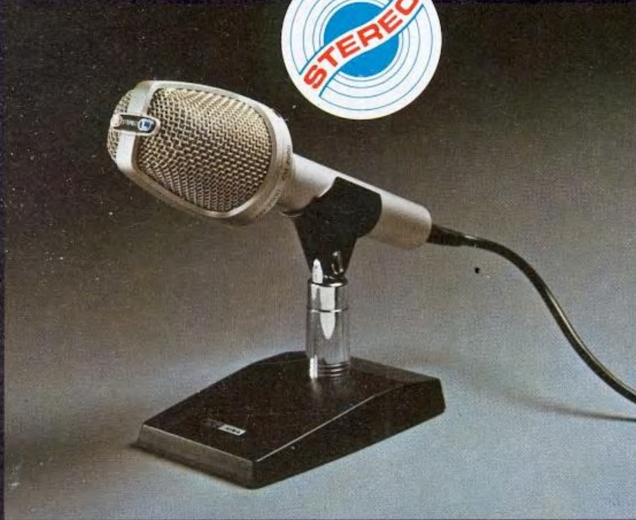
CM-2000* Elektret Kondensator STEREO Richtmikrofon 50-17 000 Hz, Imp. 250 Q, Gewicht 300 g, 1,5 V, Batterie-Lebensdauer bis 4000 Std.
