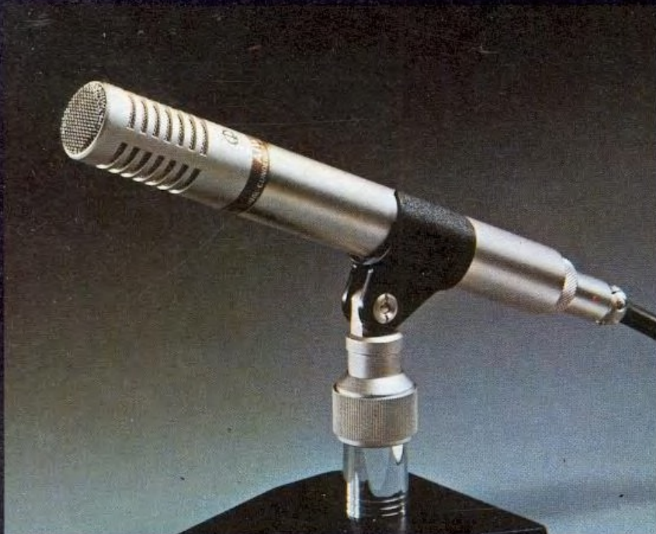
CM-1016* Elektret Kondensator Richtmikrofon Sprach- und Musikschalter, 50-15 000 Hz, Imp. 600 Q, Gewicht nur 145 g.
